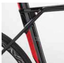
Le tubazioni sono state progettate con l'obbiettivo della massima performance aerodinamica, inclusi i foderi della forcella, dotati di piccole scanalature laterali per il passaggio dell'aria.
