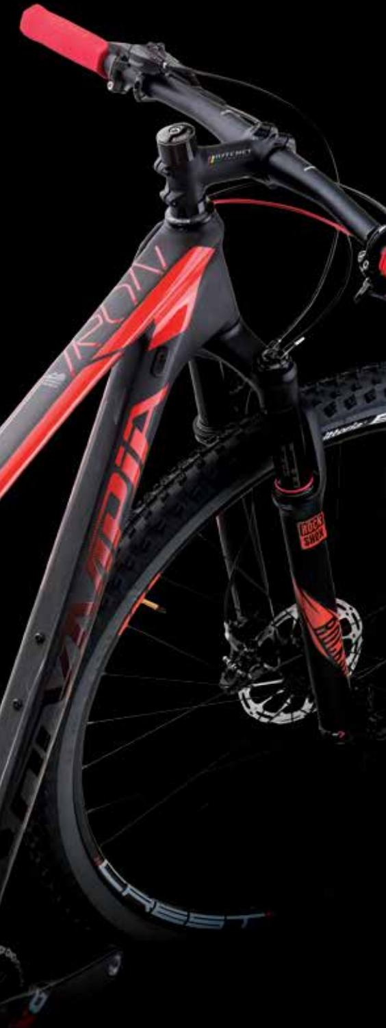
Pur mantenendo un design molto simile all'Iron 2015 le sezioni dei tubi sono state modificate, si è così ottenuto un telaio molto leggero, ma allo stesso tempo estremamente rigido, specialmente nei nodi sella e movimento centrale.
