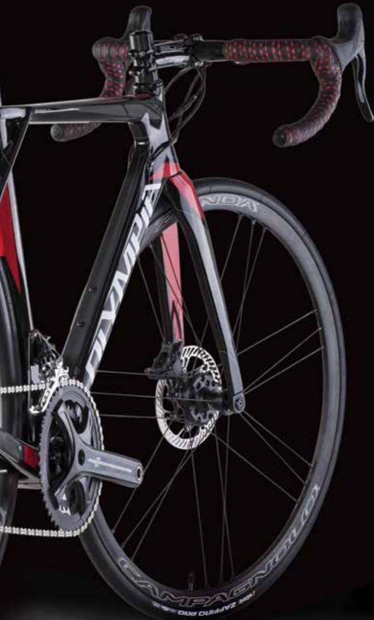
T1000, il telaio presenta uno sterzo conico con sezione aerodinamica, che si raccorda perfettamente con la forcella. Il tubo sella è caratterizzato da forma aero e nella parte inferiore ha uno scarico che alloggia la ruota, togliendo le turbolenze che solitamente si creano in quella zona.
