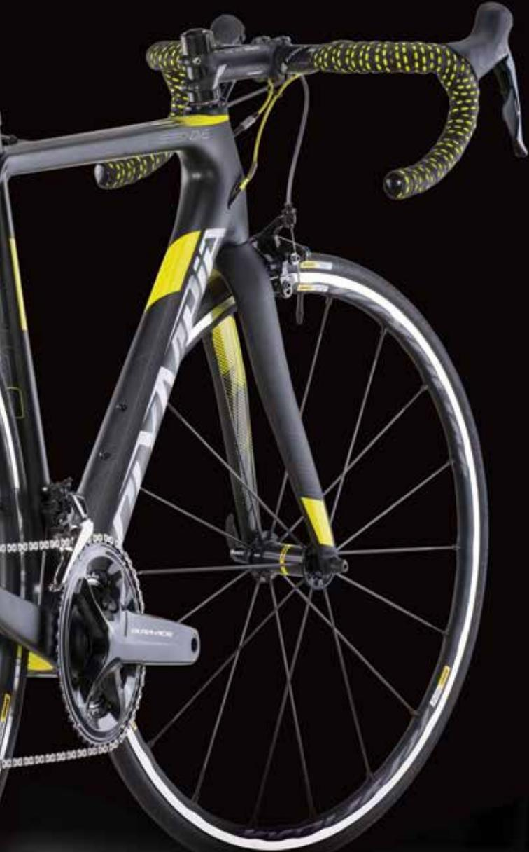
Realizzata custom, monoscocca, utilizza tre tipi diversi di fibra di carbonio: T1000, M40J e T800s. Va alla T1000 il merito della eccezionale leggerezza di questo telaio.
