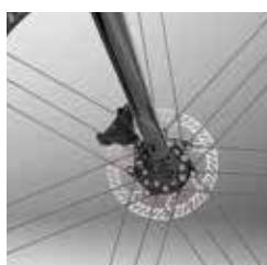
Il sistema adottato per l'impianto frenante è il Shimano Flat Mount con dischi Ice Technology. Questo sistema offre superficie di appoggio più ampia, un migliore allineamento della pinza, estetica più elegante e un migliore dissipamento del calore.
