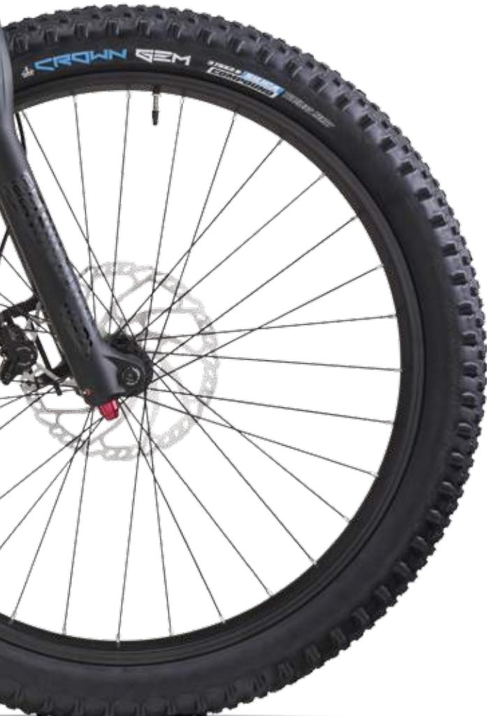
Sfruttando le proprietà delle fibre di carbonio, la top e-bike di Olympia si distingue per la sua leggerezza, per la guidabilità e il grande comfort di guida. E1X Carbon monta ruote da 27.5" plus. La cura nell'allestimento si riflette anche nella scelta della forcella Fox Float 34 o Rock Shox Yari con escursione 150mm e dell'ammortizzatore centrale che è il Fox Float DPS o il Rock Shox Deluxe RL.
