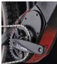
Le dimensioni compatte del motore CONTINENTAL si integrano bene nella geometria del telaio, permettendo la realizzazione di un carro corto e reattivo. Inoltre la posizione leggermente rialzata protegge il motore ed evita impatti indesiderati con il terreno.
