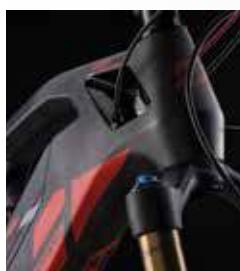
Tutta l'energia del motore elettrico con il comfort tipico delle migliori bici trail. L'angolo sterzo piuttosto aperto (66.5°), il carro posteriore ridotto, la forcella da 150 mm e le gomme 27.5"+ garantiscono divertimento su qualsiasi tipo di sentiero e dislivello.
